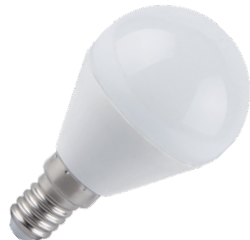
ST9100.149.05 AROUND LED smart лампа цоколь — E14 типоразмер — G45 напряжение — 220-240 V мощность — 5 W световой поток — 500 LM цветовая температура — 2700–6500 K CCT индекс цветопередачи — 80 RA диммирование — да угол рассеивания — 180° протокол связи — Wi-Fi 2.4GHz голосовое управление — Yandex Алиса; Siri размер — D37 × H113 MM
