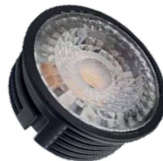
ST9101.439.07 DIM ■ черный ST9101.539.07 DIM □ белый LED-модуль DIM напряжение — 220-240 V мощность — 7 W световой поток — 560 LM цветовая температура — 3000 K индекс цветопередачи — 80 RA диммирование — да угол рассеивания — 60° размер — D50 × H20 MM
